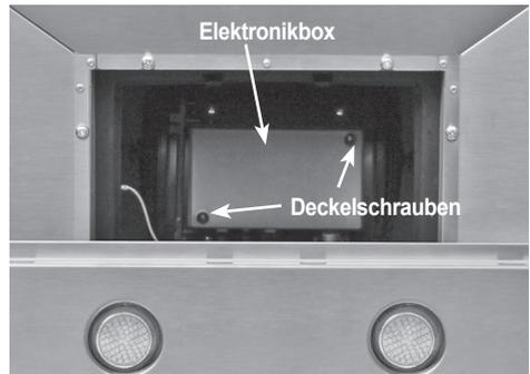
Die Abdeckung der Elektronikbox kann nach Lösen der 2 Deckelschrauben abgehoben werden. Jetzt erhalten Sie Zugang zur Platine der Steuerelektronik. Auf dieser befindet sich der Halter der Schmelzsicherung. Defekte Sicherung mit der Klinge eines Schraubendrehers vorsichtig heraushebeln. Neue Schmelzsicherung mit etwas Nachdruck in die Halterung einsetzen (Abb. 6b).
